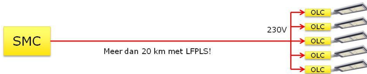
Figure 5: Stuursysteem met Segment Controller
